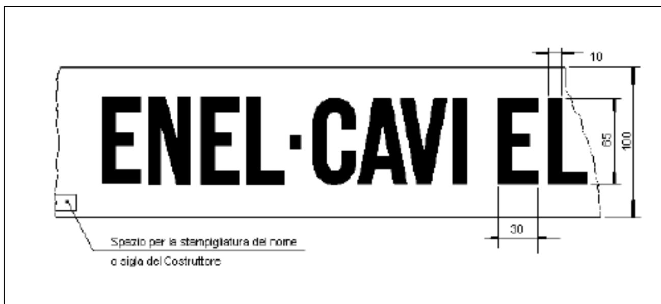
Figura 8 – Nastro di segnalazione
